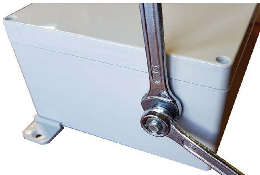
Рисунок 4.3 Затяжка гайки терминала
